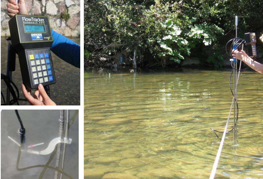
Fotografía 10-2.- Realización de aforo desde Puente de Sama, mediante equipo Flowtracker.
